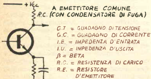
Fig. 4 - Due configurazioni di circuiti.
