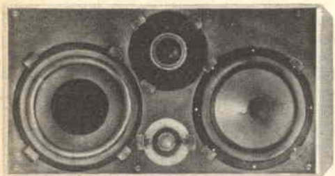
Il modello Beovox 5700 della Bang & Olufsen impiega per i bassi un radiatore ausiliario visibile a sinistra.
